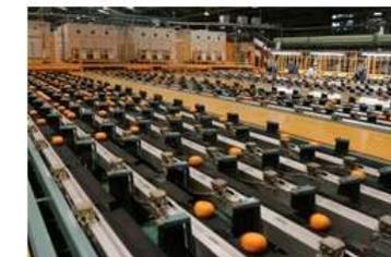
ミカちゃんマークのマルエム柑橘出荷組合に所属する三ヶ日みかん農家が収穫したみかんは、家庭での選別の後、農家自身のトラックでJAみっかびの光センサー選果場(東洋1と言われてています!)へ運び込まれます。そこでは、全てのミカンが一個ずつ個別に「糖度、酸度、外観、大きさ」などで機械的に分類されてそれぞれの出荷段ボールへ箱詰めされます。実に三万トン(一個100gとして300000000個=三億個ものミカンが、一個ずつ測定されるってすごくない!?)
